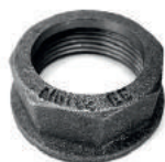
Nakrętka odmiany A symbol A/G 1 ¼, z gwintem wewnętrznym G 1 ¼ wg ISO 228-1
